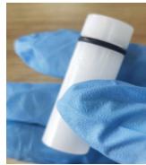
6.将O形圈安装在样品柱卡槽内,一只手下按压样品杯,另一只手推入柱塞,需要左右旋转轻轻推入、压紧柱塞,使粉末样品表面平整致密。
