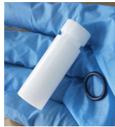
6.将O形圈安装在样品柱卡槽内,一只手下按压样品杯,另一只手推入柱塞,需要左右旋转轻轻推入、压紧柱塞,使粉末样品表面平整致密。
