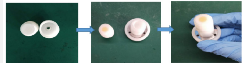
液体样品测试: 组装样品杯
