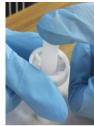
6.将O形圈安装在样品柱卡槽内,一只手下按压样品杯,另一只手推入柱塞,需要左右旋转轻轻推入、压紧柱塞,使粉末样品表面平整致密。
